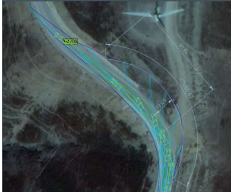
Figure 4-12 : Elargissement du remblai gauche du virage
